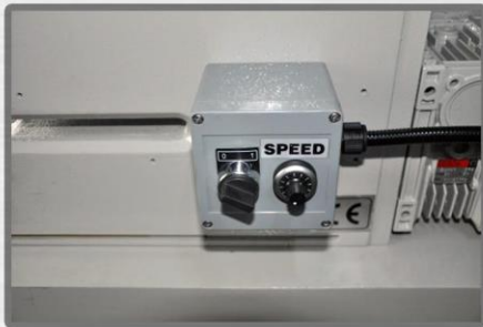
Değişken Hız Kontrolü
