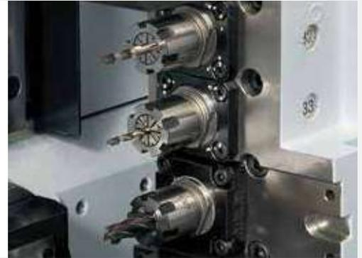
1. SPINDLE FRONT DRILLING UNI
