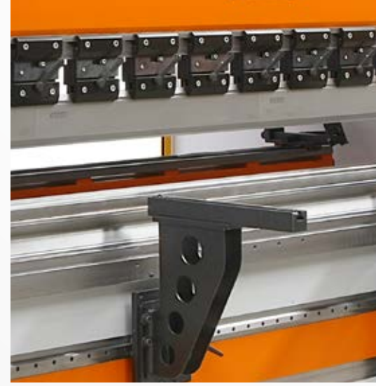
Promecam üst kalıp sıkma sistemi (Clamping) (S) Elle hızlı sökülüp takılabilen Promecam tipi üst kalıp sıkma sistemi
