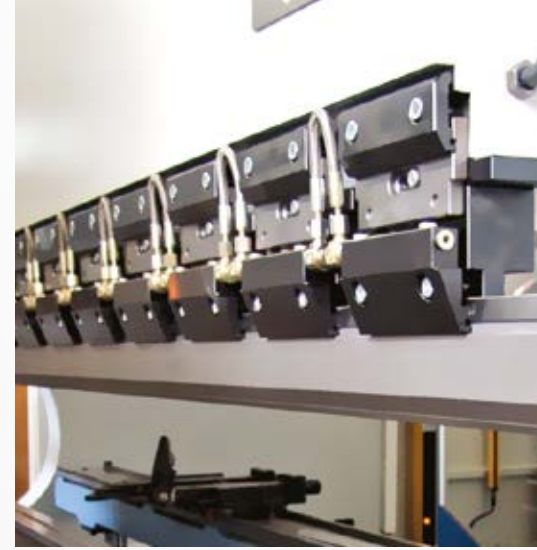
Hidrolik Kalıp Sıkma Sistemi (O) Hidrolik kalıp tutma sistemleri, hava ihtiyacı olmadan sadece hidrolik yardımıyla kalıpları otomatikman sıkılaştırır, düzeltir ve ortalar. Setup zamanlarının kısaltılması ve otomasyonlu abkant presler için mükemmel çözümlerdir.
