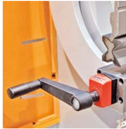
Manuel Bombeleme Sistemi (S) Bükülen parçanın her noktada ve eşit büküm açısında olmasını sağlayan manuel bombeleme sistemi.
