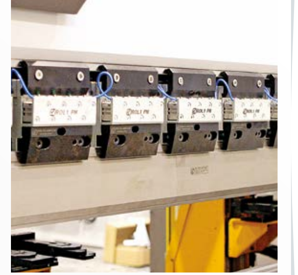
Pnömatik Kalıp Sıkma Sistemi (O) Pnömatik kalıp sıkma sistemleri, basınçlı hava yardımı ile kalıpları otomatik olarak sıkar ve merkezlemesini yapar. Setup zamanlarının kısaltılması ve otomasyonlu abkant presler için mükemmel çözümlerdir.
