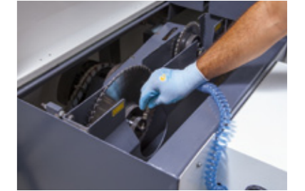
Pnömatik takım değiştirme sistemi sayesinde testere değişimi çok kısa bir sürede gerçekleştirilir. Pneumatic quick tool changing system
