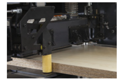
50 - 1500 mm arasında çalışan yan dayama Side alignment system (from 50 mm upto 1500 mm)
