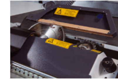
Testere Ünitesinin Otomatik Açı Ayarı Automatic Tilt Adjustment of Saw Unit
