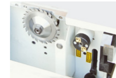
Kolay Çizici Testere Ayarı Quick Adjustment of Scoring Saw
