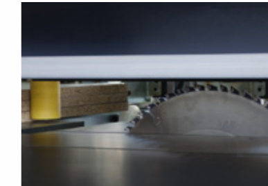
Testere, arabasındaki enkoder sayesinde makine boyunca geri gitmeden parça genişliği kadar açılır. Böylelikle kesim süreleri kısaltılmış olur. Equipped with an encoder, saw blade projects with respect to panel width to save time.
