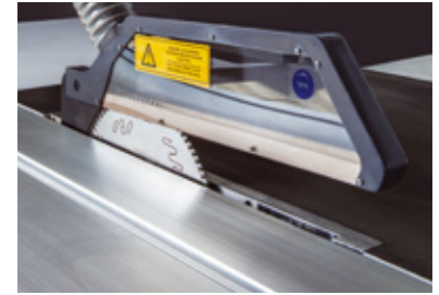
Testere Ünitesinin Otomatik Yükseklik Ayarı Automatic Height Adjustment of Saw Unit
