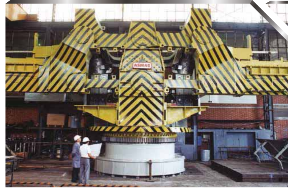
Daimi Döküm Tesisi Pota Tareti 121ton Makina Ekipman İmalatı Mühendislik: VAI - Avusturya
