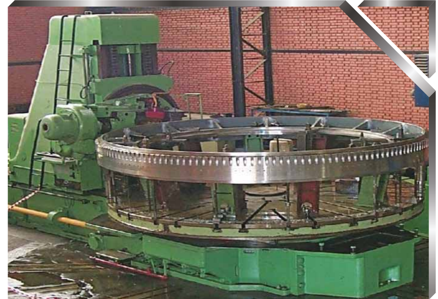
Dişli Açma Tezgahı Ø7.000 mm, Mod : 42 Gear Cutting Machine
