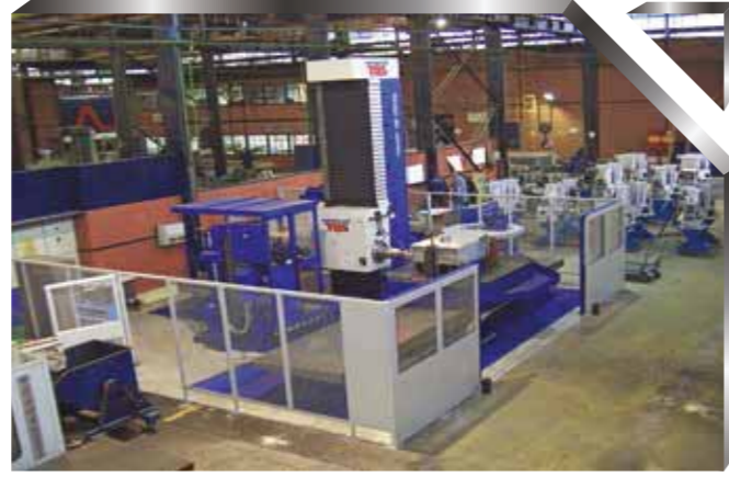
CNC Ø130 Bohrwerk x: 3.500 mm, y: 2.500 mm, z: 1.250 mm
