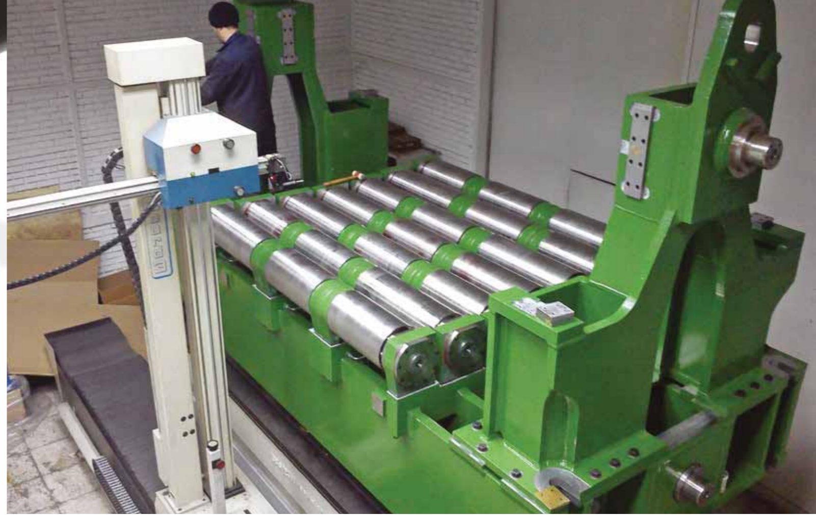
CNC Kontrollü 3-Boyutlu Ölçme ve Markalama Tezgahı CNC Controlled, 3-Dimensional Measuring and Marking Machine
