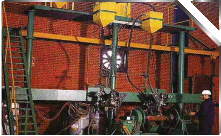
Weldclad Tozaltı Sert Kaynak Kaplama Makinası Weldclad Submerged Cladding Machine
