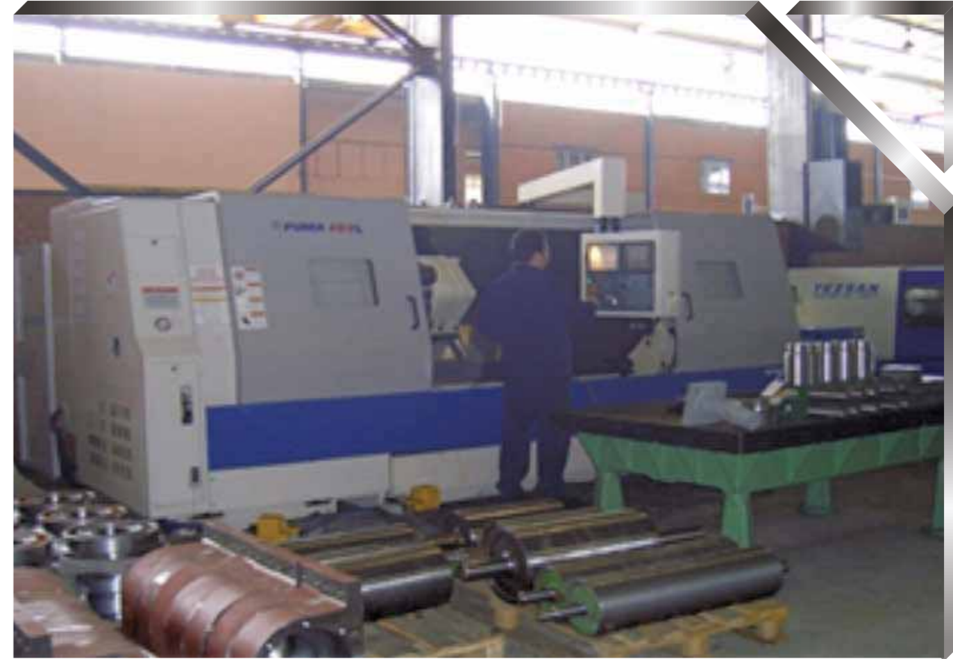
CNC Torna CNC Lathe Ø: 700 mm, L: 2.000 mm
