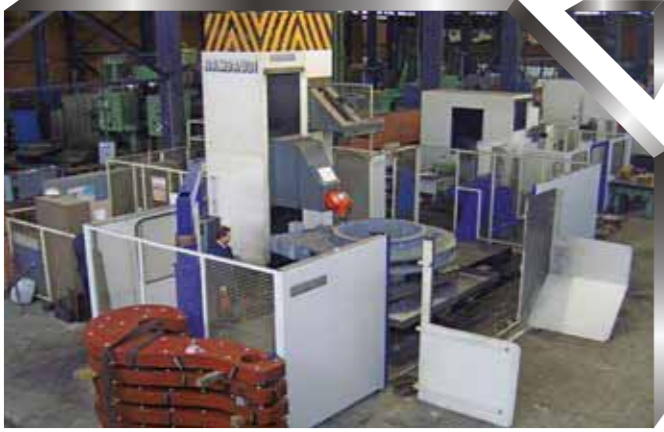
Rambaudi RX-2000 x:2.600 mm, y: 1.800 mm, z: 1.200 mm
