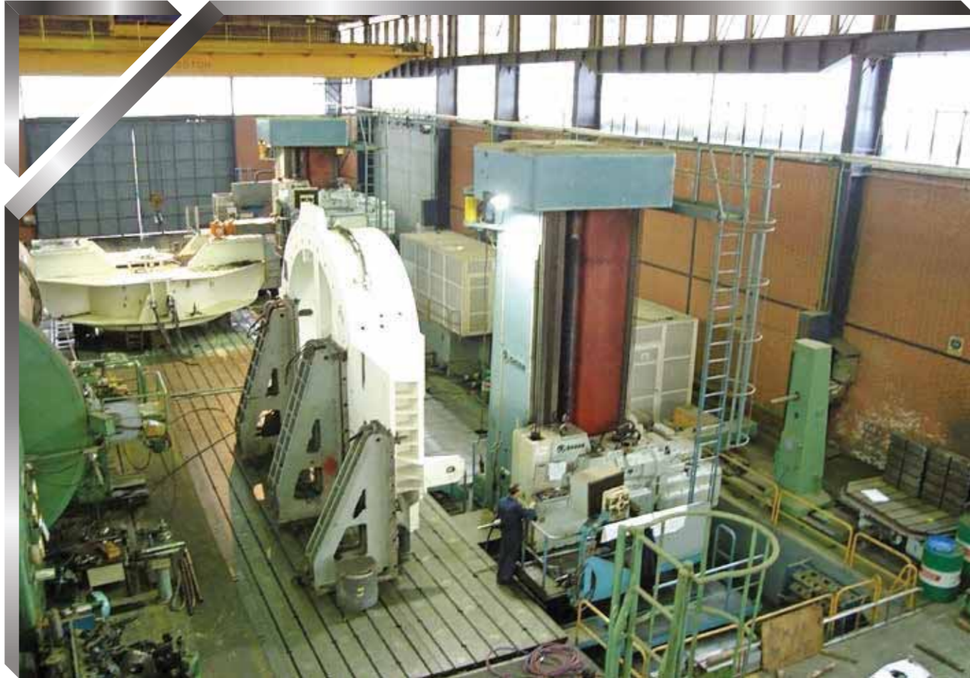
CNC Yatay Delik İşleme & Frezeleme Tezgahı (2 x CNC ø160, 23.000mm x 3.800mm x 4.700mm) CNC Horizontal Boring & Milling Machine
