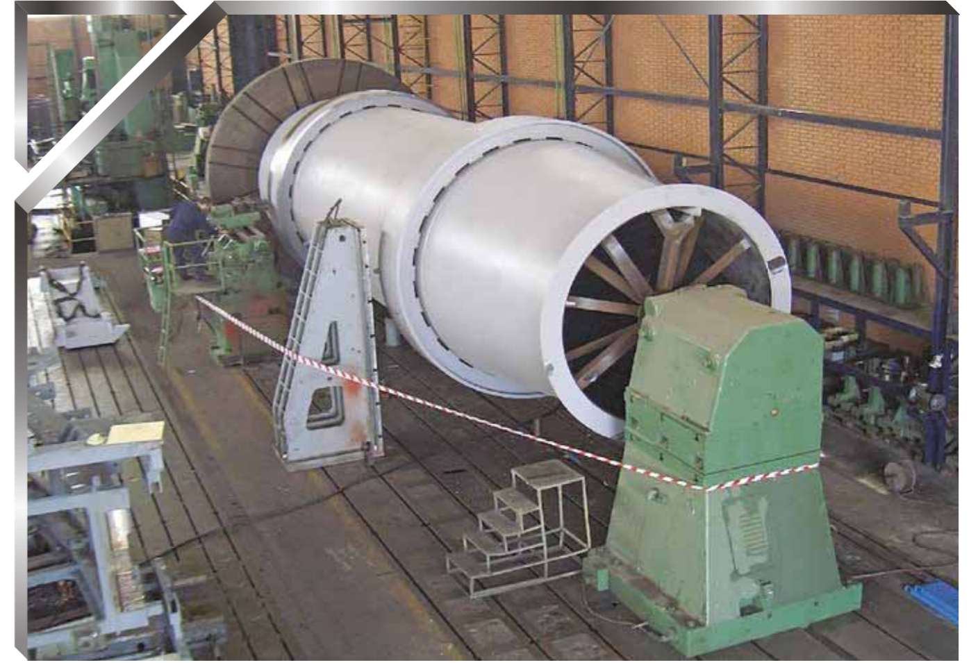
Ağır Yatay Torna Ø5.500 mm, L : 23.500 mm Heavy Horizontal Lathe
