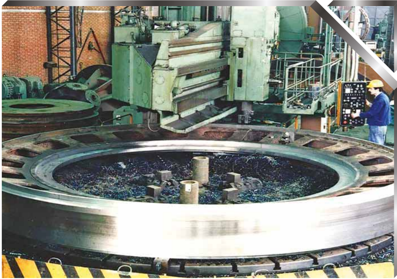
Büyük Dik Torna Ø10.500 mm, h: 3.500 mm Heavy Vertical Lathe
