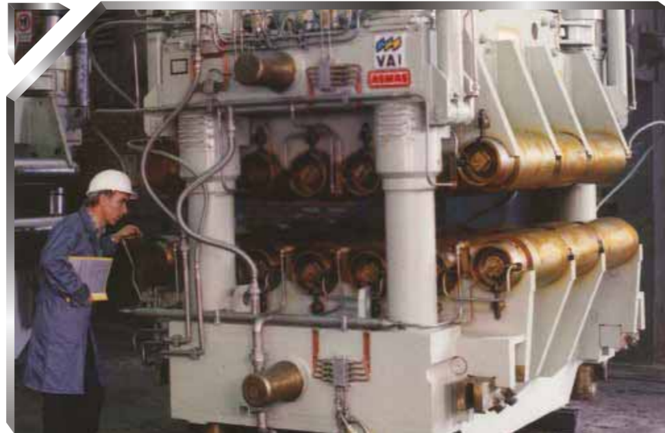
No.3 ve 4 Daimi Döküm Tesisi Ekipmanları 1.900 ton Makina Ekipman İmalatı Mühendislik: VAI - Avusturya
