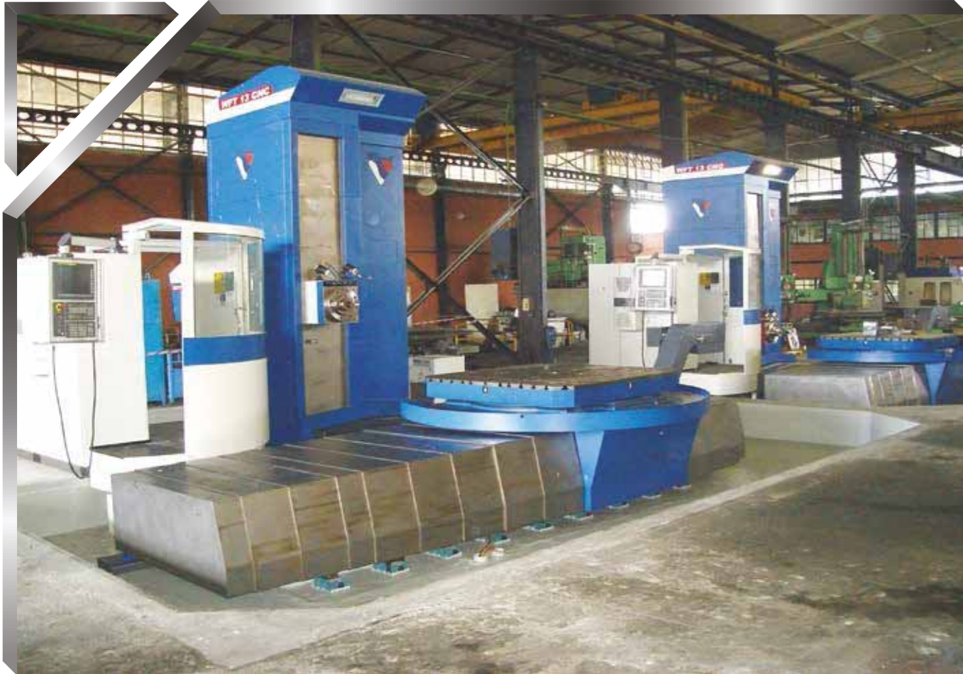
CNC Yatay Delik İşleme & Frezeleme Tezgahı (CNC Ø130, 2.500 mm x 2.000 mm x 1.250 mm) CNC Horizontal Boring & Milling Machine
