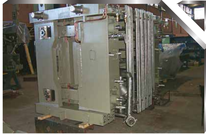
Daimi Döküm Makinaları Segmentleri Continuous Casting Machines Segments
