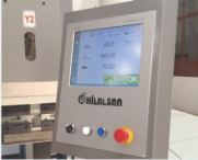
● CNC Cybele Touch 8-12 kontrol ünitesi CNC Cybele Touch 8-12 control unit
