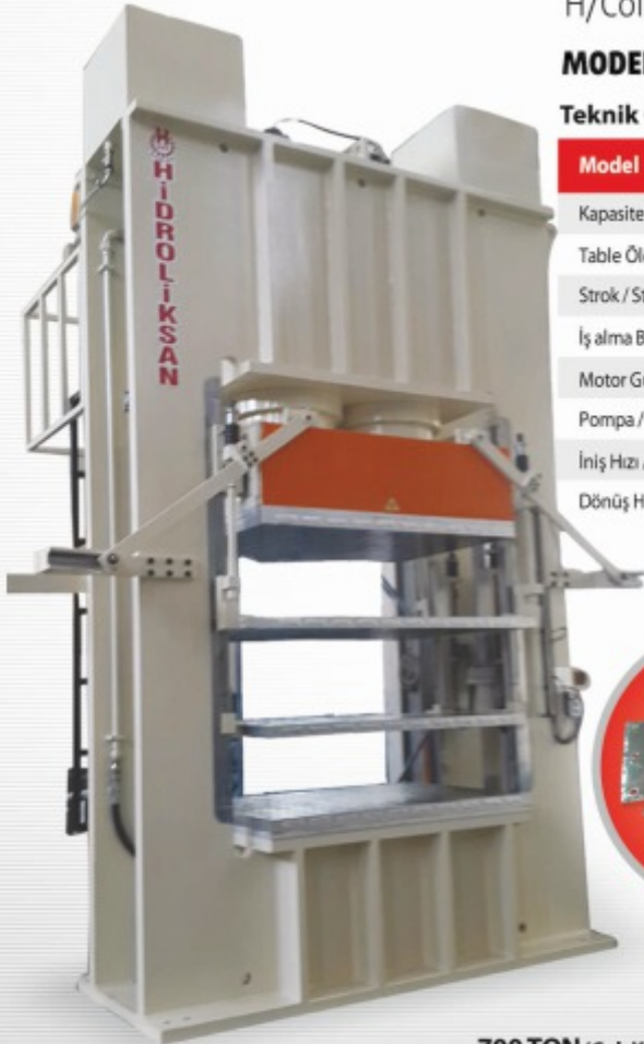
700 TON (Çok Katlı Tabla) 700 TON (Multi Layer Table)
