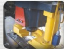
(Opsiyonel / Optional) Hidrolik Sıyıcı Sistemi Hydraulic Stripper
