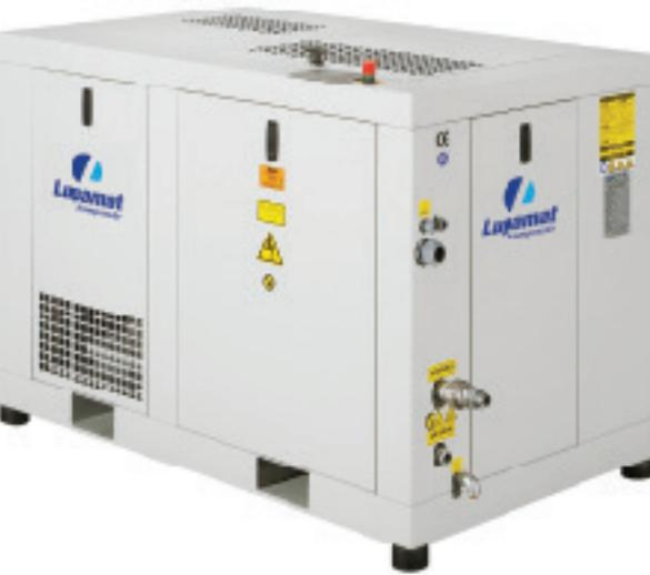
Lupamat Booster kompresörleri, 7,5, 10 ve 13 bar'lık emiş basınç seçenekleri ve 40 barlık hava çıkış basıncıyla verimli ve ekonomi sağlar. PET şşe ve gıda sanayii üretiminde olduğu gibi diğer sektörlerde de kombinasyon bağlantısı ile en zor şartlarda sürekli çalışmasıyla kesintisiz hava ihtiyacını karşılamaktadır. Lupamat'ın kendi üretimi olan kompresör bloğu, maksimum verimlilik sağlayan uzun ömürlü konsantrik emme ve basma subaplan bulunmaktadır.
