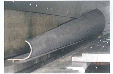
Özel alt ve üst kalıp ile konik direk imalatı
