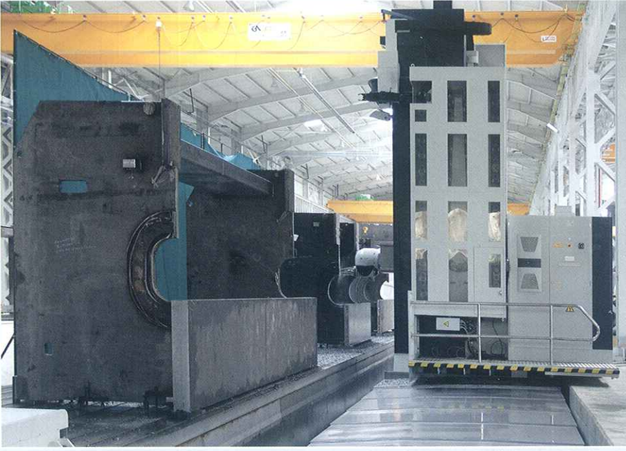
Yüksek hassasiyetli CNC işleme merkezlerinde 28 m uzunluğa kadar tek seferde imalat yapılabilir.
