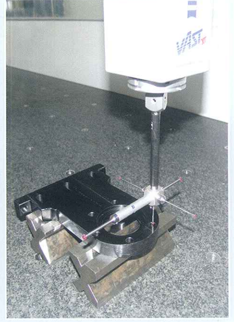
3 boyutlu ölçüm cihazı ile 1 mikrona kadar hassas ölçüm yapılabilir.
