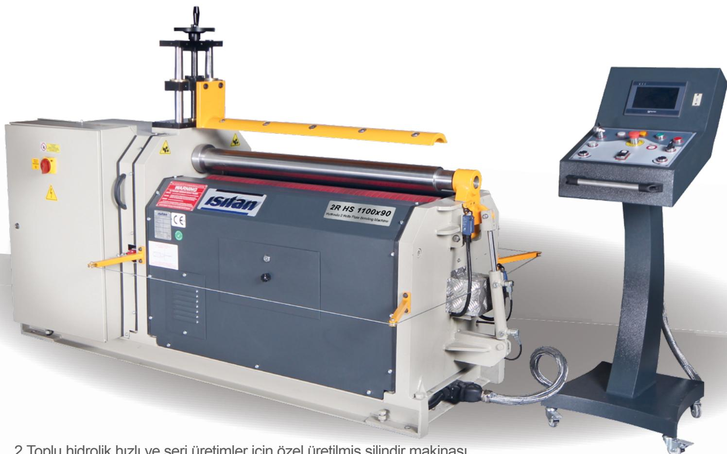
2 Toplu hidrolik hızlı ve seri üretimler için özel üretilmiş silindir makinası
