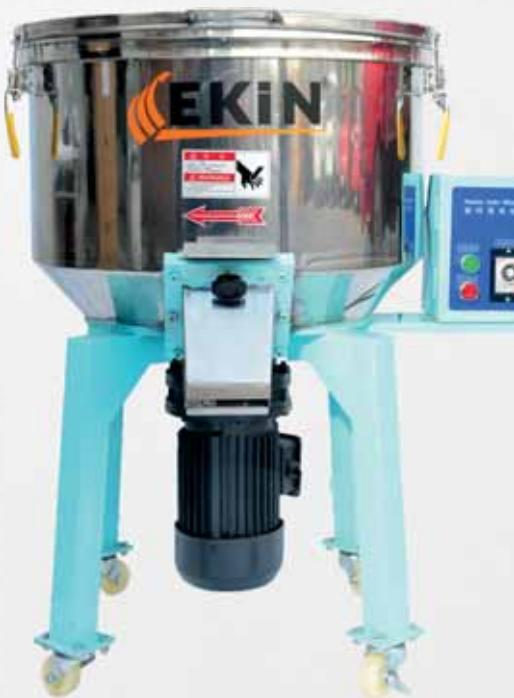
Plastik endüstrisinde orijinal hammadde ile kırılmış olan malzemenin yada boyanın homojen bir şekilde karıştırılması için kullanılır.
