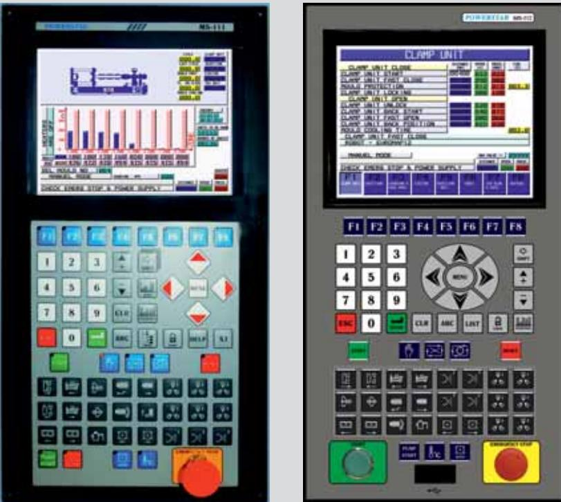
Geliştirilen kontrol sistemleri ile kullanım, LCD ekran seçenekleriyle çalışma menüsü ve sayfalar arası geçişler kolaylaştırılmıştır. Ayrıca cihaz ile mekanik birimler arasındaki haberleşme hızlı ve hassas hale getirilmiştir. Farklı dil seçenekleri bulunmaktadır. Pano yapımında yüksek kalitede Avrupa menşeli salt malzemeleri kullanılmaktadır.
