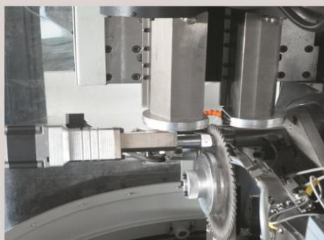
Motorlu sıkma sistemi ile soğutmalı testereleri sorunsuz bileme. Patentli akıllı tırnak sistemi ile diş zarar vermeden temassız ilerleme ve değişken adımlı grup dişlerde otomatik atlama.
