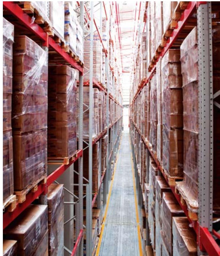
→ Sistemdeki koridorların mümkün olduğunda uzun olması verimliliği artırmaktadır. İstifleme cihazı için bazı projelerde zeminde manyetik bantlar da tercih edilebilir. Özel çözümlerde 16 metre yüksekliğe kadar depolama imkanı bulunmaktadır.
