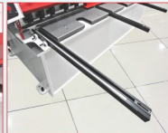
● T Kanallı 1500mm uzunluğunda cetveli gönye 1000mm uzunluğunda ön kollar Squaring arm with scale & T-Slot & Tilting stop ( L=1500 mm ) Support arms ( L= 1000mm )
