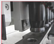
● Kesim sırasında sacın hareket etmesini engelleyen baskı pedacı / Hold down pads which ensures the fixing of sheet metal during the cutting process
