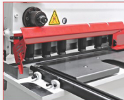
● Açılabilir 1000mm uzunluğunda ön parmak koruma kafesi 1mt flip-up finger guards cage
