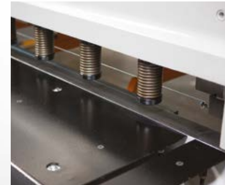
Kesim Çizgisi Aydınlatma Gölge Teli (standart). Kesilecek sac üzerine iz düşüm oluşturarak, kaliteli ve hassas kesimler yapılmasını sağlar.
