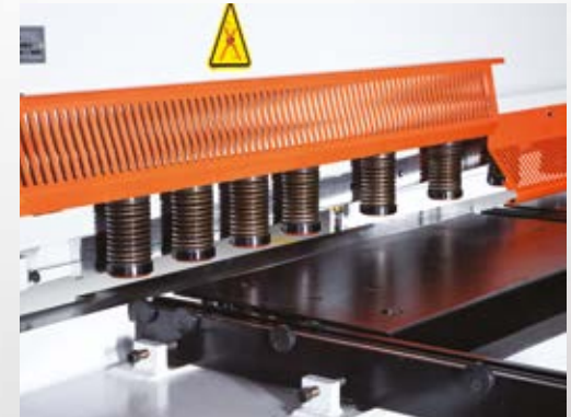
Açılabilir Parmak Koruma (standart). Açılı ve çizgili kesimlerin rahat kontrolü için baskı silindirlirinin 1 mt.'lik ön kısmı kullanıcı isteğine bağlı olarak açılabilir. Switch kormalı.
