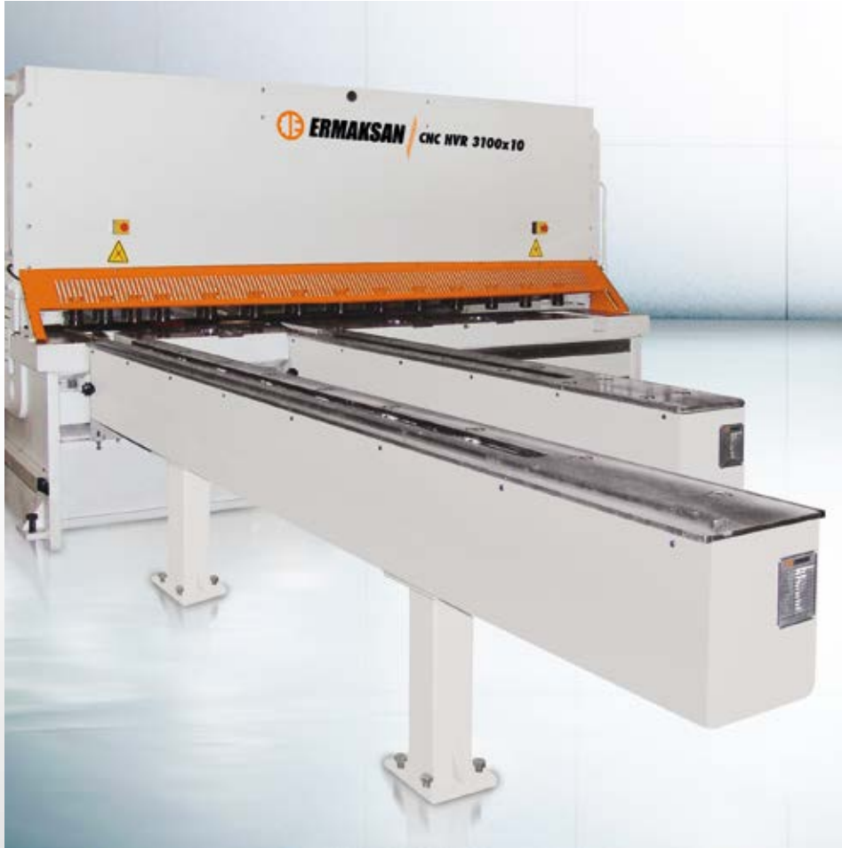
Ön Sac Sürme Sistemi (opsiyonel). Geniştirliği ayarlanabilen, yüksek hassasiyetli ve yüksek hızlı ön sac sürme sistemi üretim kapasitenizi en üst seviyelere taşıyacaktır.
