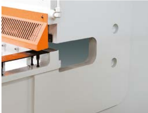
Boğaz (standart). 350 mm standart boğaz derinliği ile kesme boyundan daha uzun sacların kesimlerine olanak sağlar.
