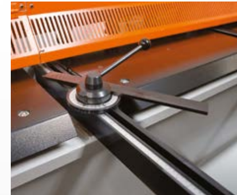
Açı Ayarlı Gönye (opsiyonel). Açılı kesimlerde, yüksek hassasiyetli, kolay kesim yapabilme imkanı sağlar.
